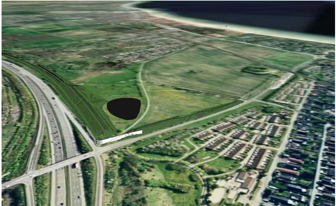
Visualisering af den nye støjvold set sydfra. Visualiseringen viser forslag A med den korte støjskærm i hjørnet mellem motorvejen og Cementvej.
